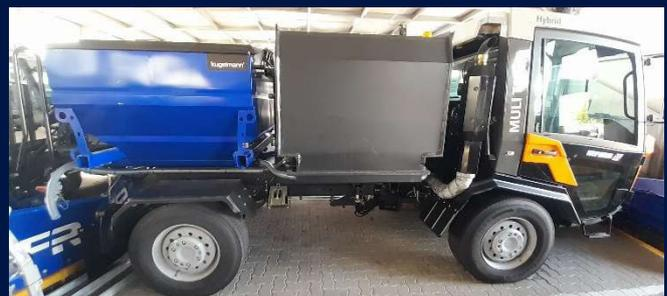
Kugelmann Duplex mit Fronttank FS 30 / FS 100 Feuchtsalzstreuer / Solesprüher für verschiedene Trägerfahrzeuge
