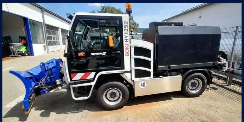
Reform Kiefer BOKI 2-Achser mit Kugelmann Soleprüher FS 100, Ausbringung über Schlauchhaspel oder Streuteller
